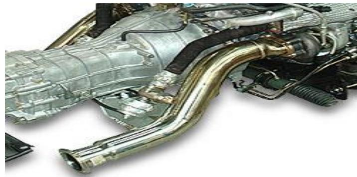
توربین بین منیفولد هوای خروجی وانباره اگزووز قرار می گیرد، تمامی گازهای خروجی موتور (اگزووز) از محفظه
